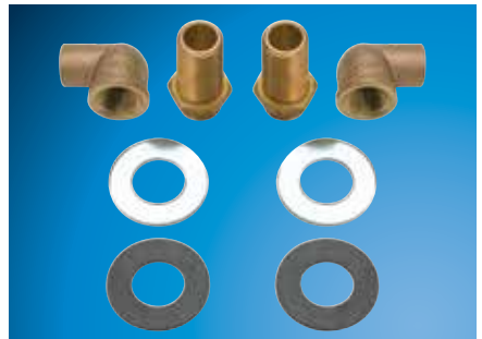
0451KL0700 KIT DE CONEXIONES DE ENTRADA PARA MONTAR EN LA PARED Simplifica la instalación del grifo en la pared, en el espacio estándar de la protección contra salpicaduras. El kit incluye dos nipples de 1/2 pulg. NPS cada uno, codos macho-hembra de 1/2 pulg. NPT, arandelas y contratueras.
